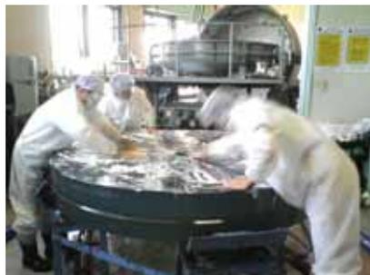
まずは水洗い。そしてアルカリ性溶液で古いアルミニウムを溶かし、重曹の粉で研磨。
