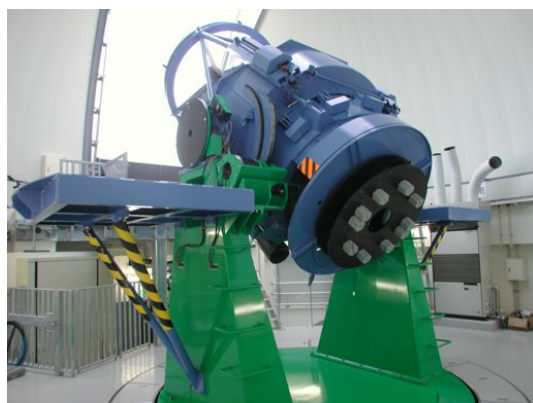
図1 口径1.5m かなた望遠鏡。架台部(緑色)は新しく導入されたもので、5 度/秒の高速駆動を実現する。
