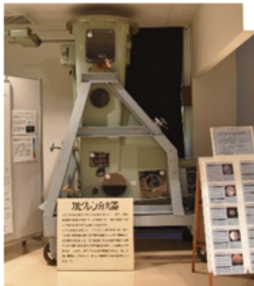
188 cm反射望遠鏡の 初代分光器 「カセグレン分光器」
