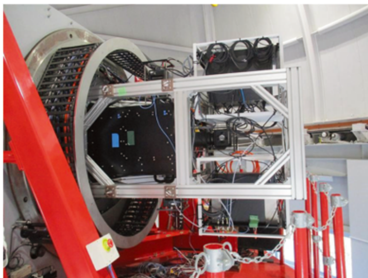
2021年8月から観測運用を開始した可視3色高速撮像装置TriCCS。 3台のカメラを内蔵しておりカラー撮像ができる。
